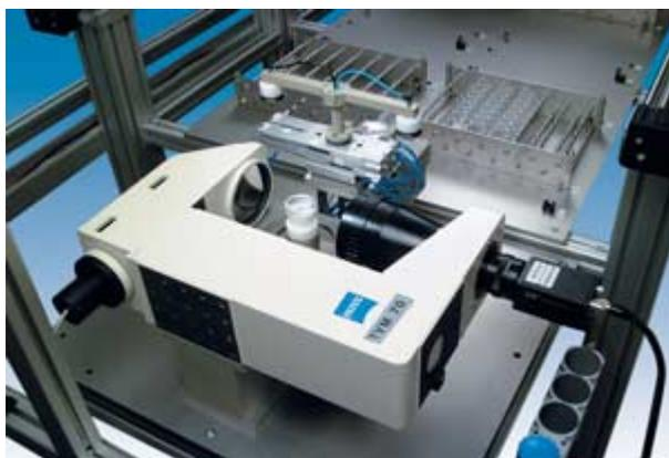
Präzisionsmesseinrichtung mit telezentrischer Abbildung
